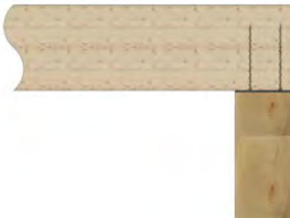
d) Renfort de compression perpendiculaire à un appui à l'aide de vis entièrement filetées
