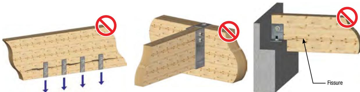
FIGURE 5 • Configurations propices à la traction perpendiculaire au fil
