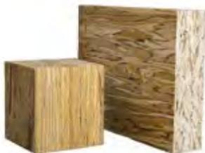
**FIGURE 7 d** • Bois à copeaux parallèles (PSL)
