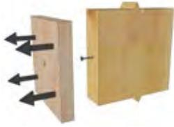
On calcule la résistance qu'offre l'élément latéral au passage de la tête de vis selon s'il qu'il s'agisse d'une plaque d'acier, d'une pièce en bois ou d'un panneau structural. La résistance dépend de l'épaisseur de l'élément latéral ( $t_1$ ) et du nombre d'attaches ( $n_F$ ).
