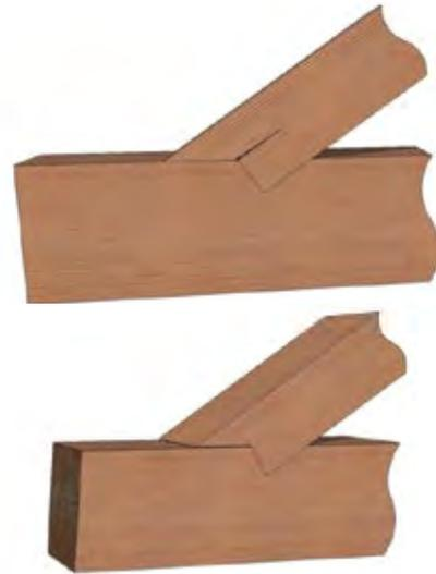
**FIGURE 68** • Traction perpendiculaire au fil dans un embrèvement arrière mal conçu
