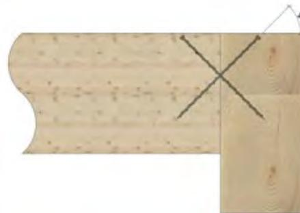
b) Assemblage d'une poutre secondaire sur une poutre principale à l'aide de vis entièrement filetées installées à 45 degrés
