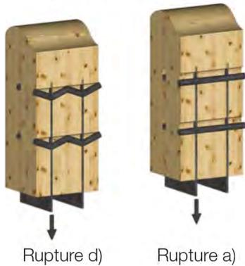
On utilisera donc l'équation a) avec une résistance de 9,8 kN/plan de cisaillement.
