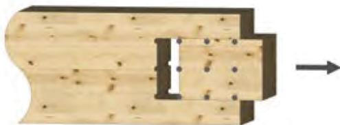
Le déchirement de groupe peut être considéré comme la combinaison d'une rupture en cisaillement de files et d'une rupture en traction nette. Ce type de rupture fragile ne peut se produire qu'en cas de chargement en traction parallèle au fil. On calcule la résistance d'un assemblage au déchirement de groupe en utilisant la résistance au cisaillement des deux files d'extrémités, ainsi que celle en traction de l'aire nette ( $A_{PGi}$ ) (CSA O86, art.12.4.4.5).
