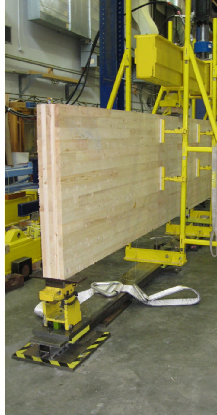
Essais de résistance sur des éléments en CLT chez FPInnovations © Photos : FPInnovations
