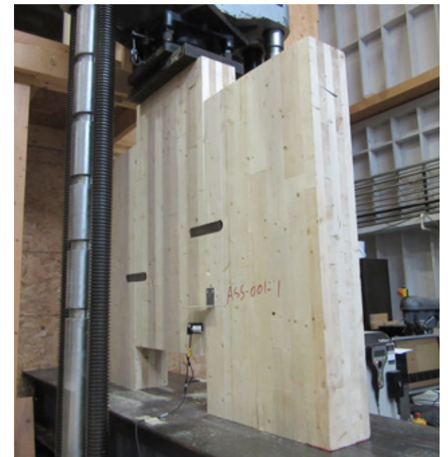
Insertion des clés de cisaillement dans un mur de refend et essais chez FPIinnovations © Photo : FPIinnovations
