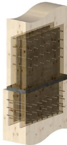
Plaques de connexion pour relier verticalement les panneaux de CLT et des murs de refend © Photo : Stéphane Groleau
