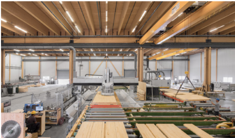
Machine à commande numérique à l'usine des Chantiers Chibougamau Ltée. © Nordic Structures
