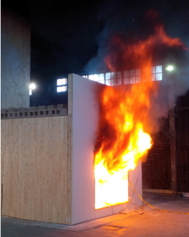
Test de démonstration à grande échelle après 10 minutes © Photo : Nordic Structures
