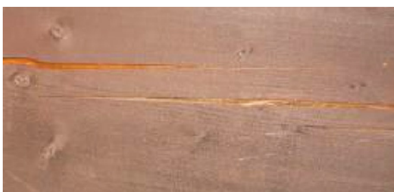
FIGURE 19 – Gerces importantes dans un gros bois de sciage
