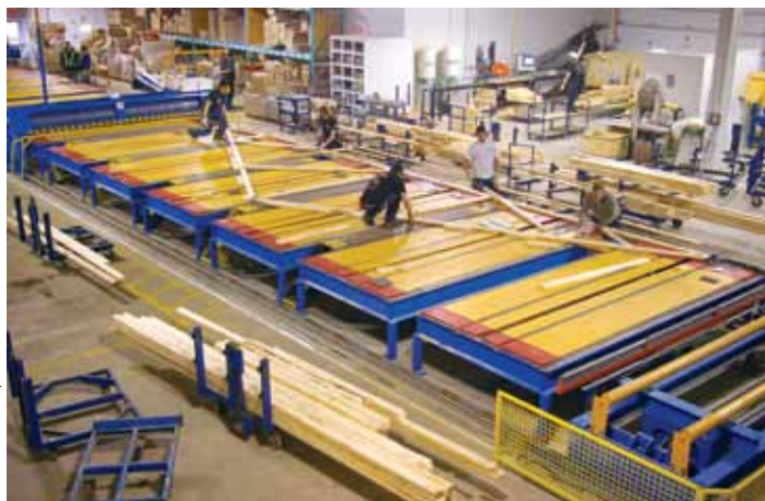
Fabrication en usine d'une ferme légère de toit
