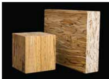
**FIGURE 16** • Bois de copeaux parallèles (PSL)
