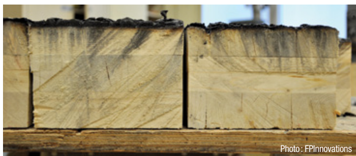
La capacité du bois à carboniser et par le fait même de se protéger contre la dégradation dans un incendie confère au CLT de bonnes propriétés de protection contre les incendies.
