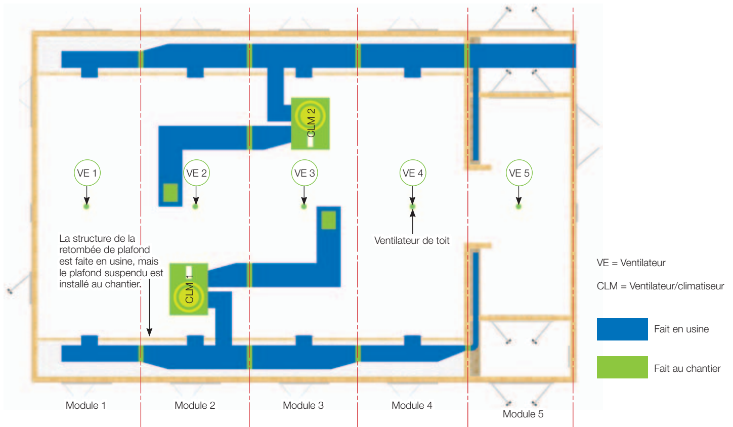
FIGURE 39 • Exemple de système de ventilation/climatisation
