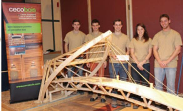
Cette passerelle haubanée est formée d'un intrigant tablier courbe qui est supportée par une structure principale rappelant la forme d'une feuille.
