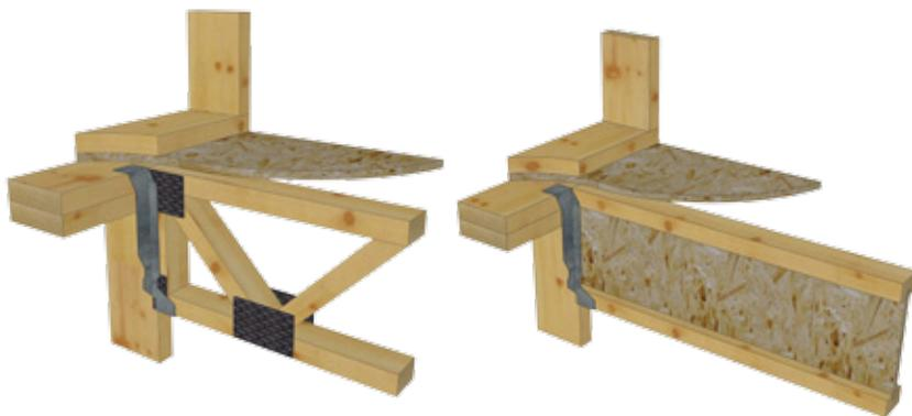
Les fermes de toit sont orientées nord-sud et appuyées sur les murs extérieurs et les murs de corridor. Des fermes à pente faible de 914 mm de hauteur (36 pouces) à 610 mm d'espacement sont utilisées.
