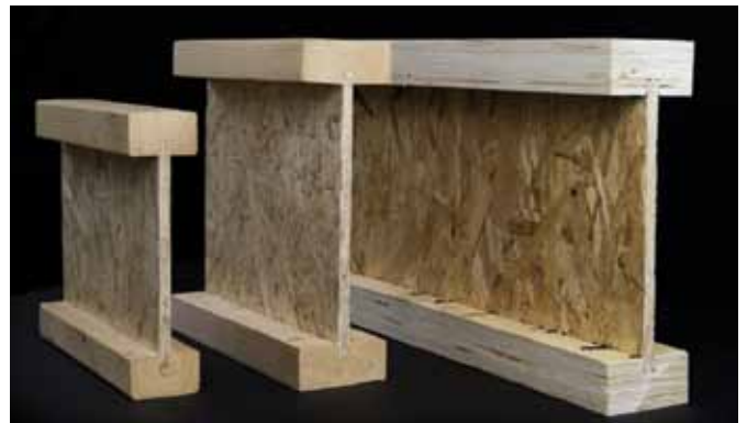
FIGURE 4 • Poutrelle de bois en I avec des semelles en bois de sciage (gauche) et en LVL (à l'extrême droite)
