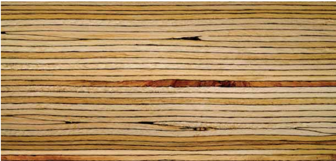
FIGURE 16 • Agencement des placages d'un bois LVL
