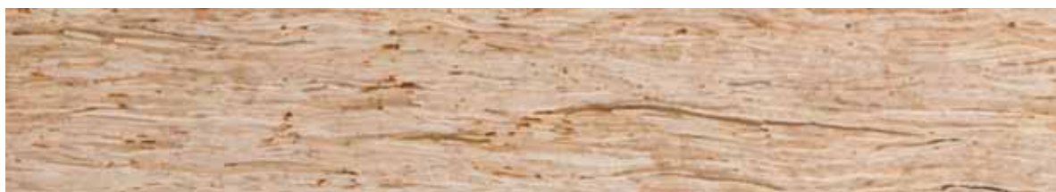
FIGURE 19 • Agencement des copeaux d'un bois LSL
