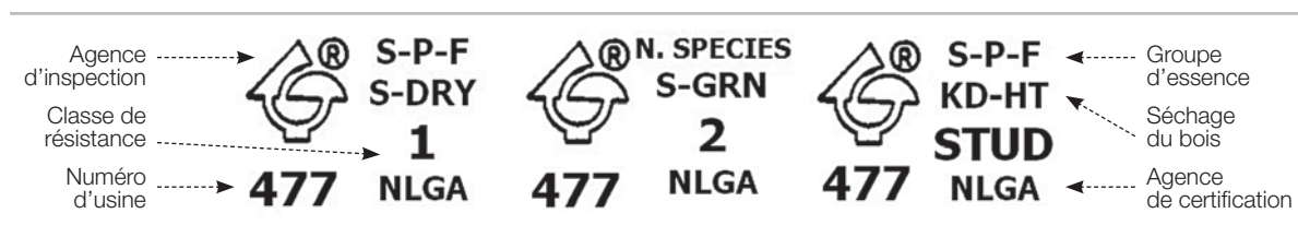
FIGURE 6 • Estampilles de qualité d'un bois classé visuellement par contrainte (source : CIFQ)
