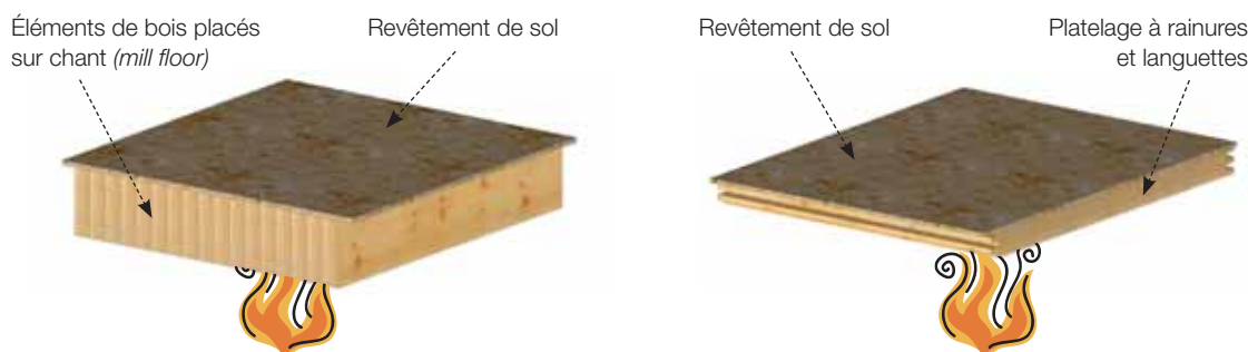
FIGURE 55 • Exemples de platelage en bois exposé au feu
