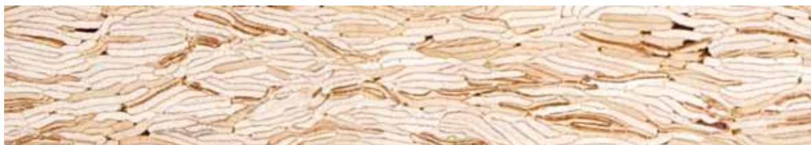
FIGURE 18 • Agencement des copeaux d'un bois PSL
