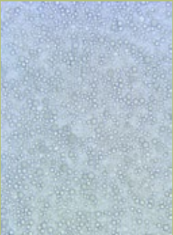
Image au microscope optique (X 400) de microsphères de Poly (méthyl méthacrylate)
