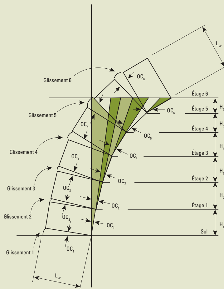
Flèche cumulée attribuable à l'élongation des ancrages de retenue
