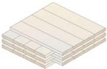
Figure 1 Épaisseurs successives de planches en bois placées en couches croisées à 90 degrés et collées les unes aux autres.
