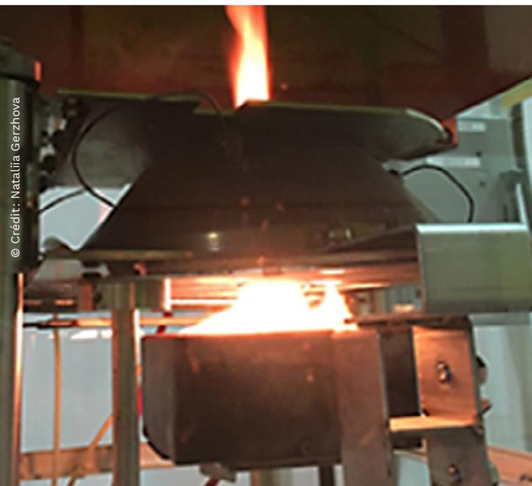
**Figure 2** L'essai d'un substrat de croissance dans le calorimètre à cône.
