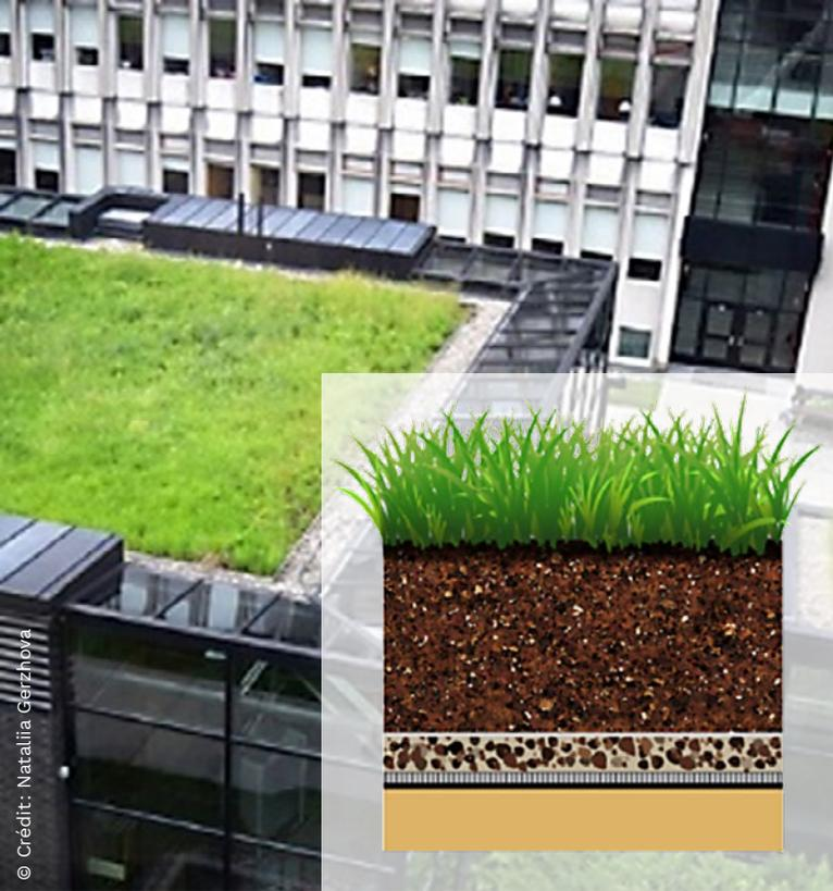
**Figure 1** Les toitures végétalisées sont composées d'un assemblage vertical de différents éléments dont les principaux : les plantes, le substrat de croissance et la couche de drainage.
