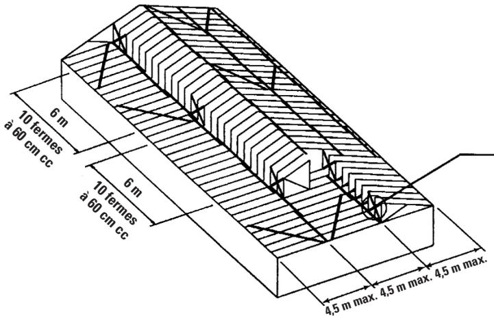
Croissillon installé à chaque extrémité du bâtiment et à des intervalles de 6 m
