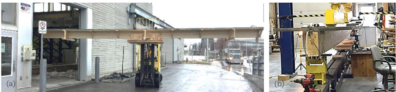
**Figure 5** (a) Transport et (b) essais de flexion du plancher BLC-BFUP.
