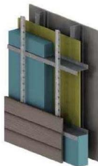
Barres Z horizontales RSI_{eff} \text{ 2,56 (R-14,5)}
