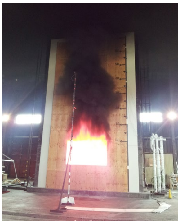
FIGURE 3 • Exemple d'un essai de comportement au feu des murs extérieurs selon la norme CAN/ULC-S134 (Photo : Conseil canadien du bois)
