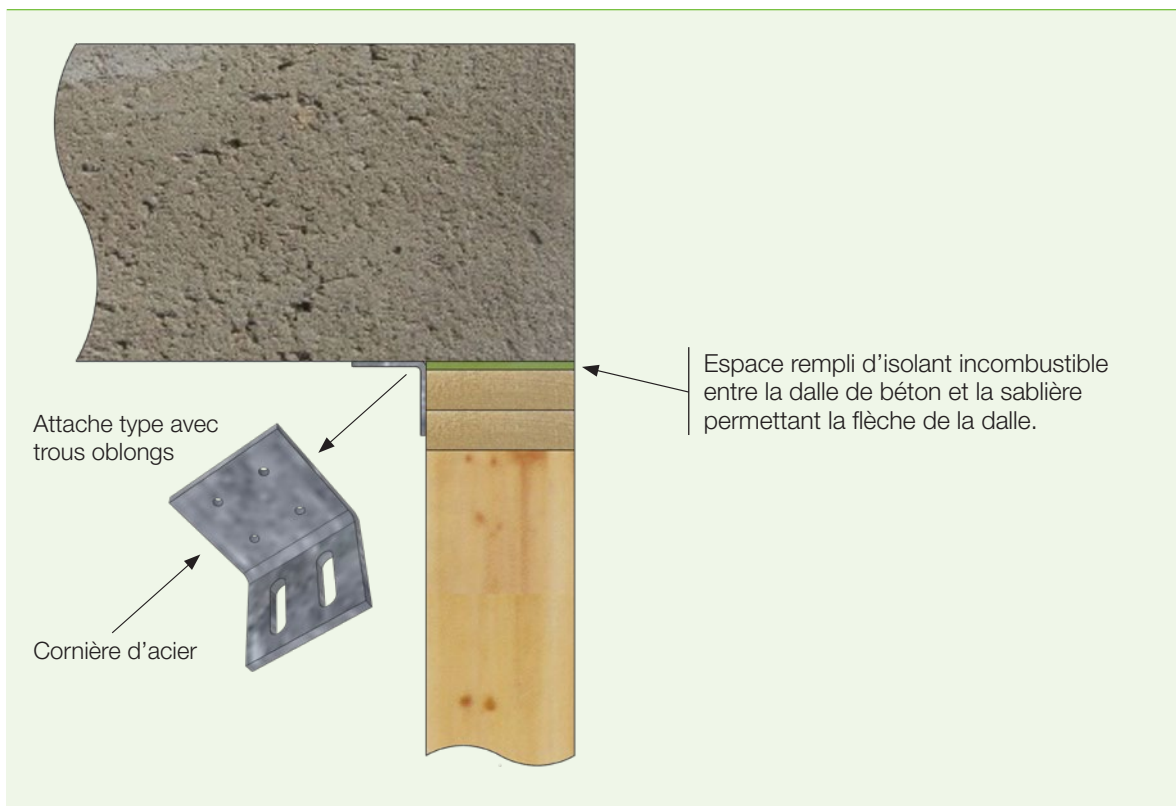
FIGURE 5 • Exemple d'attache de mur à la structure
