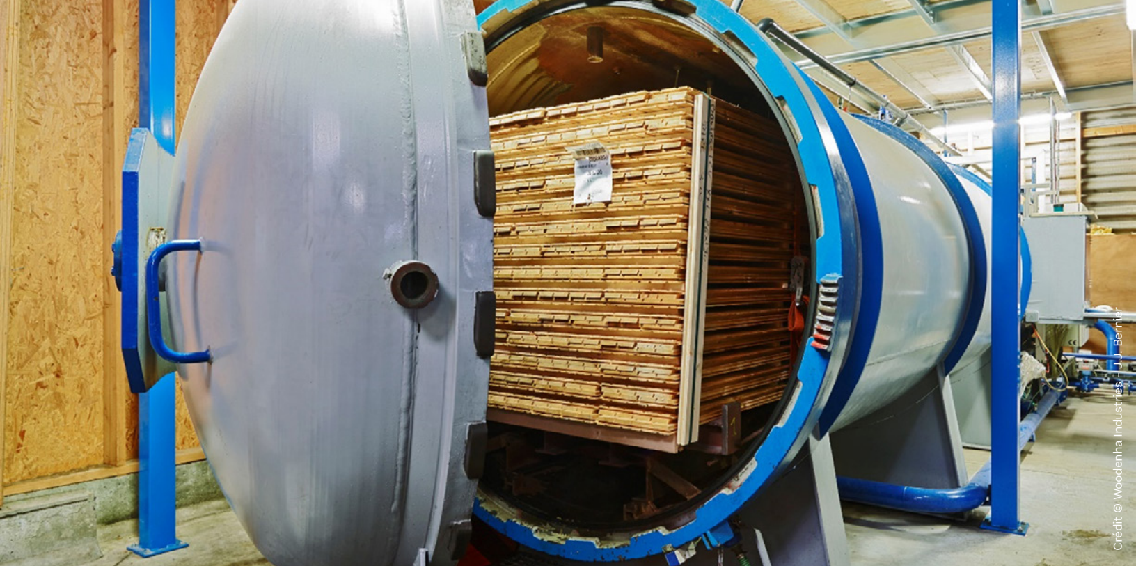
Figure 2 Autoclave vide et pression dédié à l'ignifugation dans la masse (bois et matériaux lignocellulosiques).
