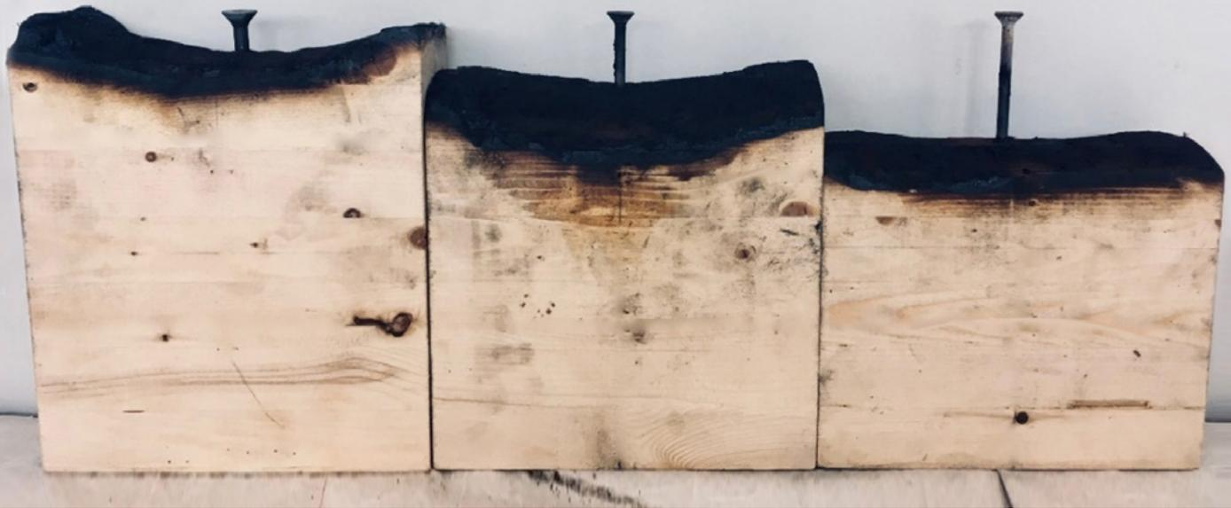
**Figure 2** Évaluation de la performance au feu d'assemblages vissés dans la construction massive pour différentes durées d'exposition, soit après 30 minutes (à gauche), après une heure (au centre) et après deux heures (à droite).
