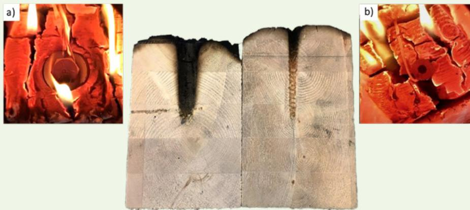
**Figure 6** Le transfert de chaleur d'attache non protégée à l'intérieur d'une section en bois massif de lamellé-collé après deux heures exposition; a) un boulon Ø 15.9x140 mm et b) une SWG ASSY® 3.8 CSK Ø10x160mm. (Source : Mathieu Létourneau-Gagnon)
