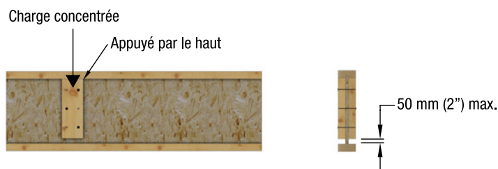
FIGURE 27 • Raidisseurs d'âme sous une charge concentrée
