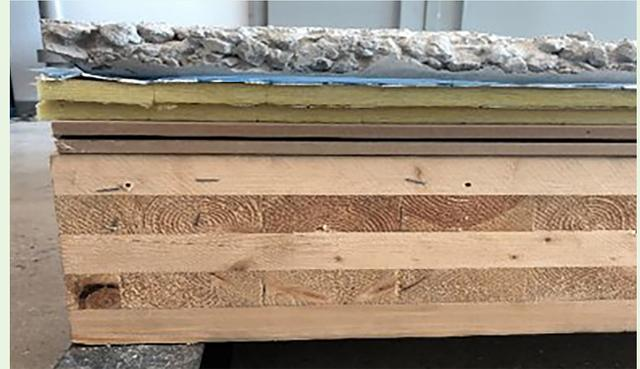
CLT 5 plis de 175 mm pour mesurer expérimentalement la transmission du son dans la structure en bois. Ces essais ont permis d'extraire les propriétés dynamiques de l'échantillon et de développer un modèle pour simuler la propagation du son dans le panneau. Les propriétés dynamiques mesurées ont été enregistrées et considérées comme des références dans le développement du modèle numérique.
