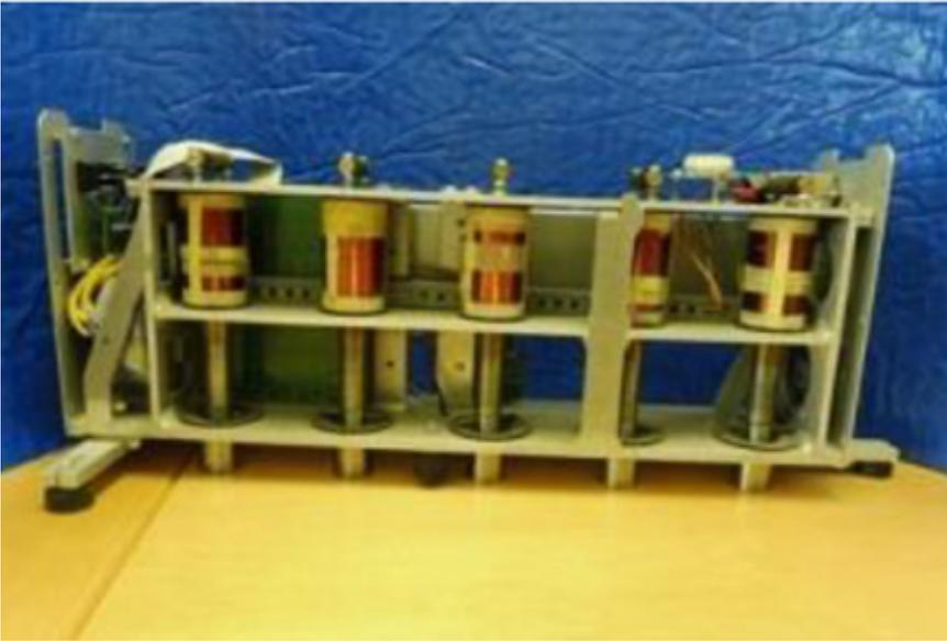
Figure 3. Machine à chocs normalisée ISO.
