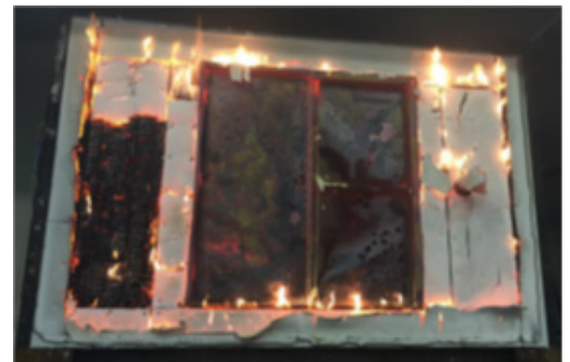
d) Mur en CLT et porte coupe-feu après l'essai CAN/ULC S104
