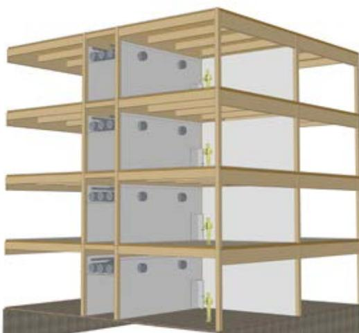
**FIGURE 53 •** Modélisation d'un système structural pannes-poutres dans deux directions de 9 m x 8 m d'un secteur de salle de classes d'une école pour le calcul de ratio de consommation de bois
