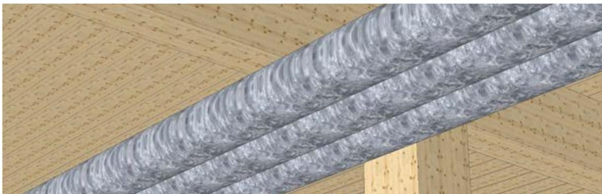
**FIGURE 63** • Image montrant l'intégration des services MEP au-dessous des poutres
