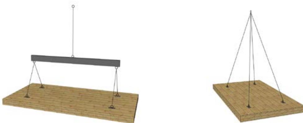
FIGURE 22 • Levage d'un panneau en CLT avec et sans palonnier
