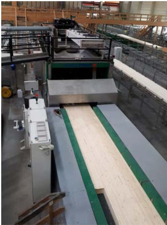
**FIGURE 8 •** Presse automatisée par collage à chaud Kallasoe
