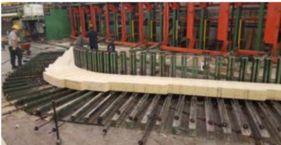
FIGURE 15 • Table d'assemblage d'une poutre de BLC cintrée
