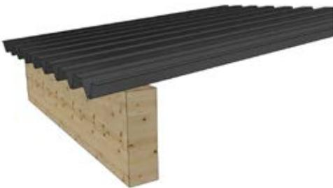
**FIGURE 48** • Poutre de bois avec pontage d'acier
