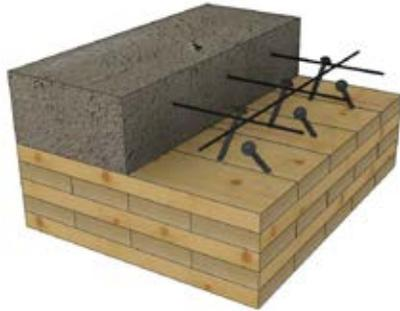
**FIGURE 40** • Bois-béton composite - Système d'assemblage par vis
