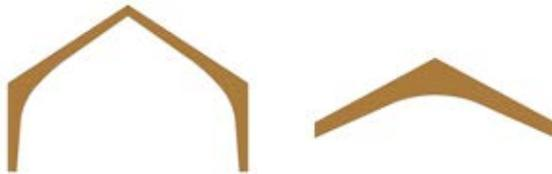
FIGURE 14 • Arc Tudor et poutre cintrée à inertie variable
