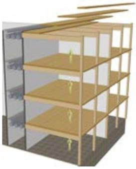
**FIGURE 56** • Modélisation d'un système structural poutres dans une direction de 4,5 m x 8 m d'un secteur de salle de classes d'une école pour le calcul de ratio de consommation de bois
