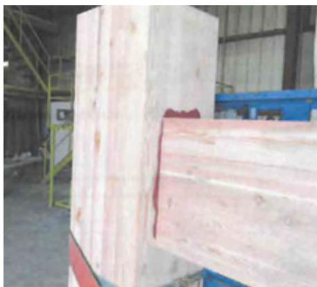
b) Assemblage poutre-à-colonne
