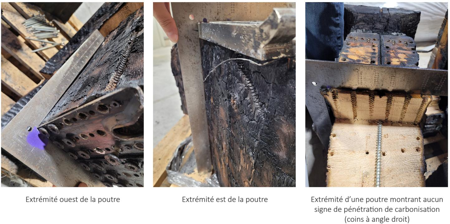
Figure 9. Observation de la pénétration de la carbonisation et de l'arrondissement des coins durant l'essai no 3 de FPIinnovations [15]
