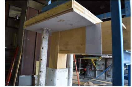
c) Assemblage poutre-à-colonne
