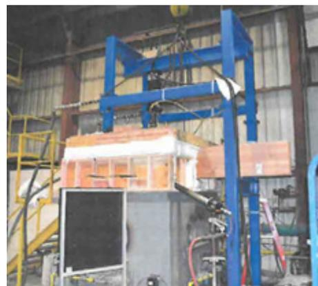
c) Dispositif d'essais de résistance au feu
