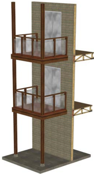
FIGURE 76 • Balcons sur appuis
