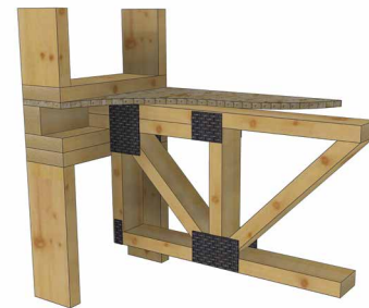
Figure 13 • Poutrelle appuyée par membrure double supérieure
